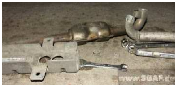
Obrázek 20: Odmontované díly (kryt, výfuk, vzduch)
