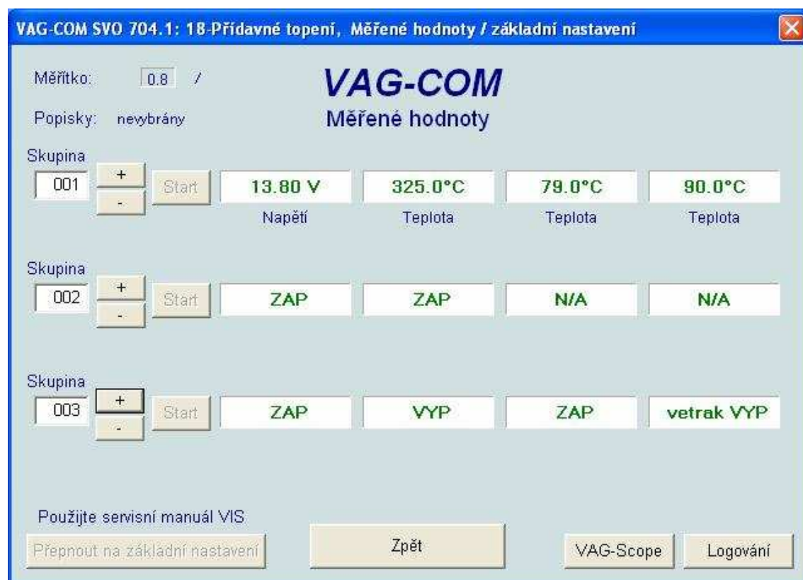
Obrázek 34: Hodnoty 3 – provoz na plný výkon (svíčka nežhaví – palivo zapnuto)
