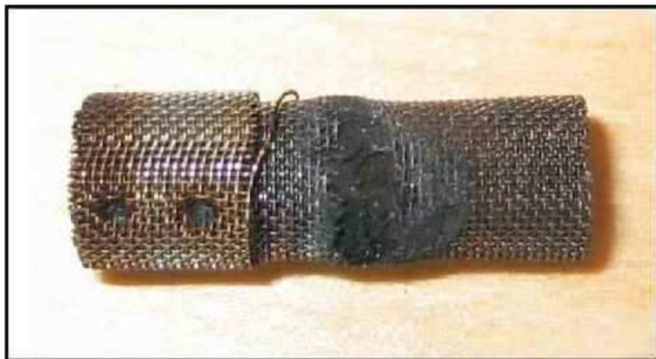
Obrázek 4: Zuhelnatěné sítko (zvětšeno)
