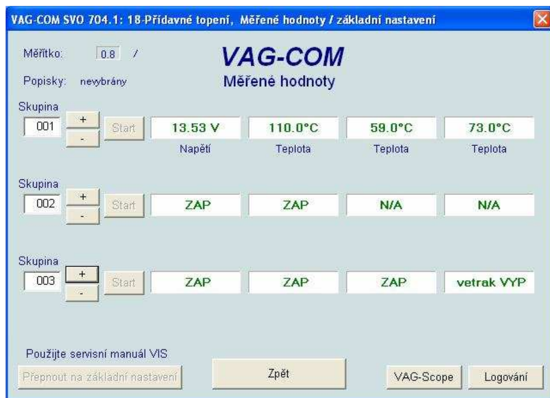
Obrázek 33: Hodnoty 2 – nabíhá hoření (svíčka žhaví- palivo zapnuto)
