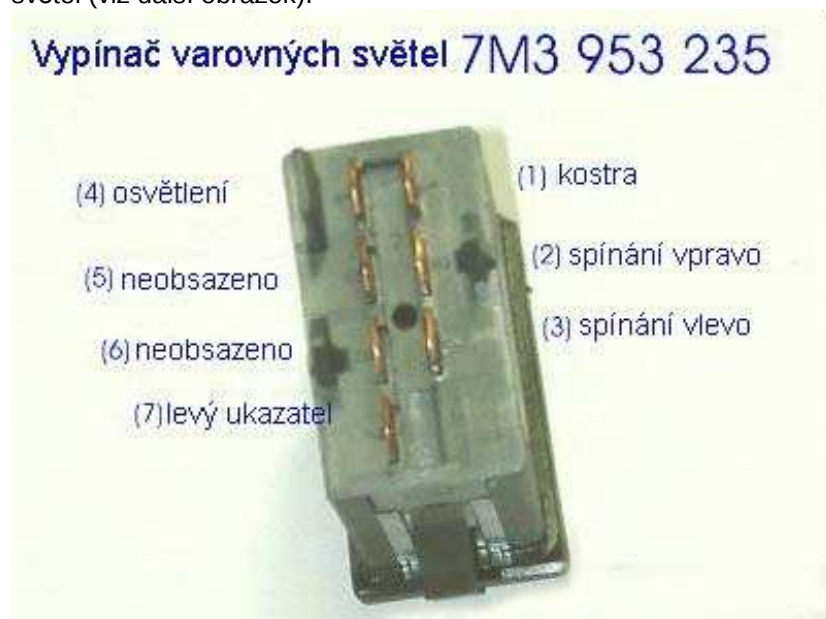
Obrázek 50: Vypínač varovných světel
