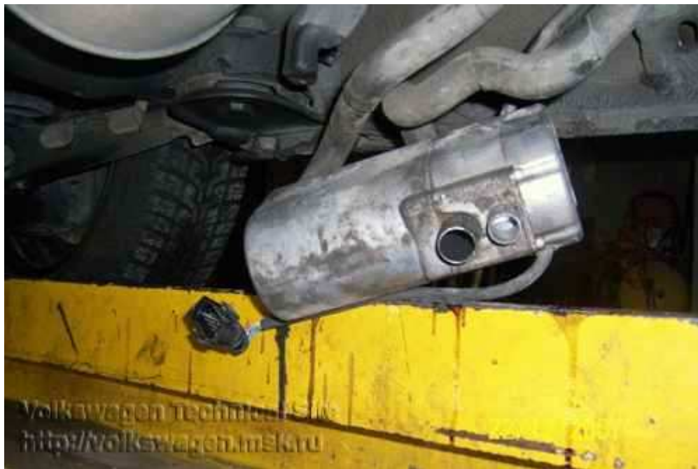
Obrázek 7: Bufík s odpojenou elektroinstalací vyscívá na hadicích vody
