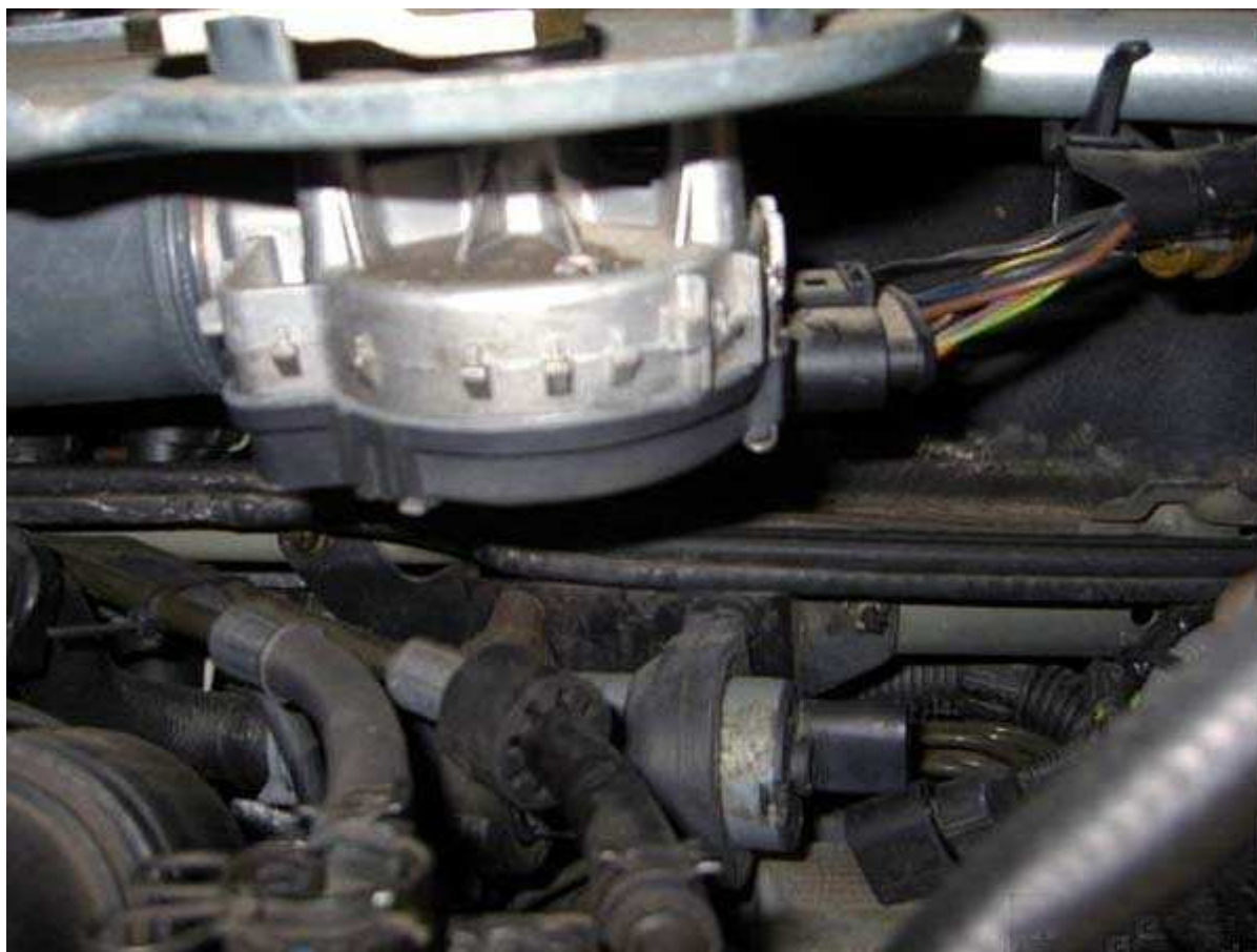
Obrázek 61: Doplnovací čerpadlo – umístění v motorovém prostoru
