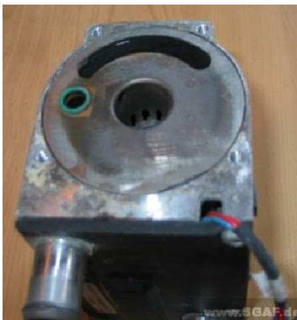
Obrázek 16: Sada hořáku s hubicí hořáku (střed) průchodka pro sítka (nalevo) výfuk (nahore)
