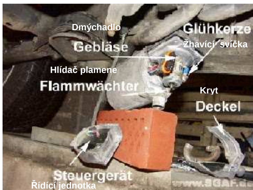
Obrázek 23: Částečně rozdělaný Bufík – popis částí
